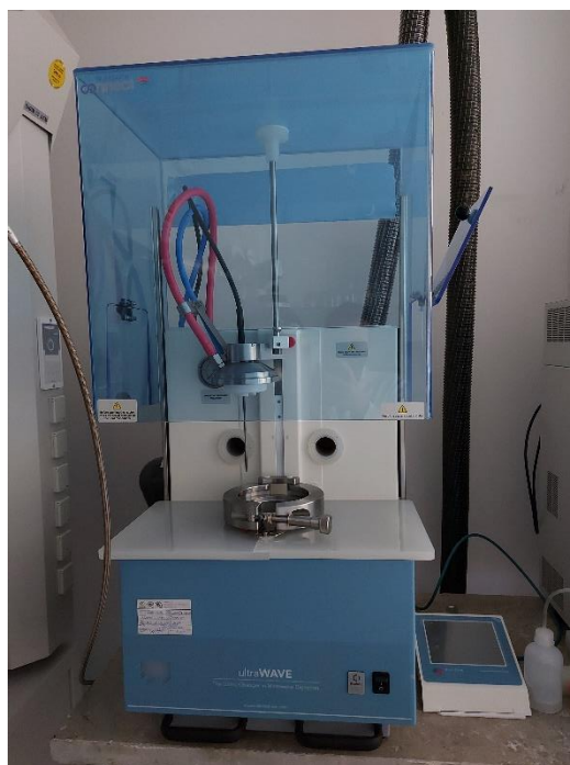
Slika 14. Jedinica za mikrovalnu digestiju korištena za razgradnju uzorka (vlastita fotografija)
