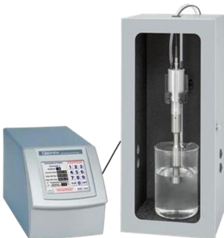
Slika 17. Uređaj za ultrazvučnu ekstrakciju Q700 (vlastita fotografija)
