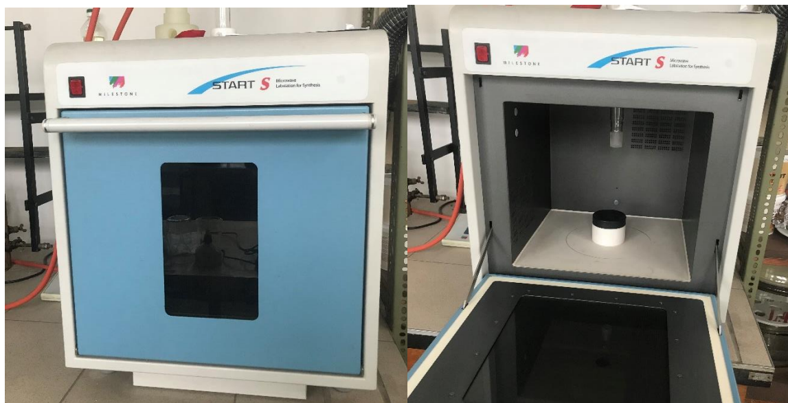
Slika 16. Uređaj za mikrovalnu ekstrakciju (vlastite fotografije)
